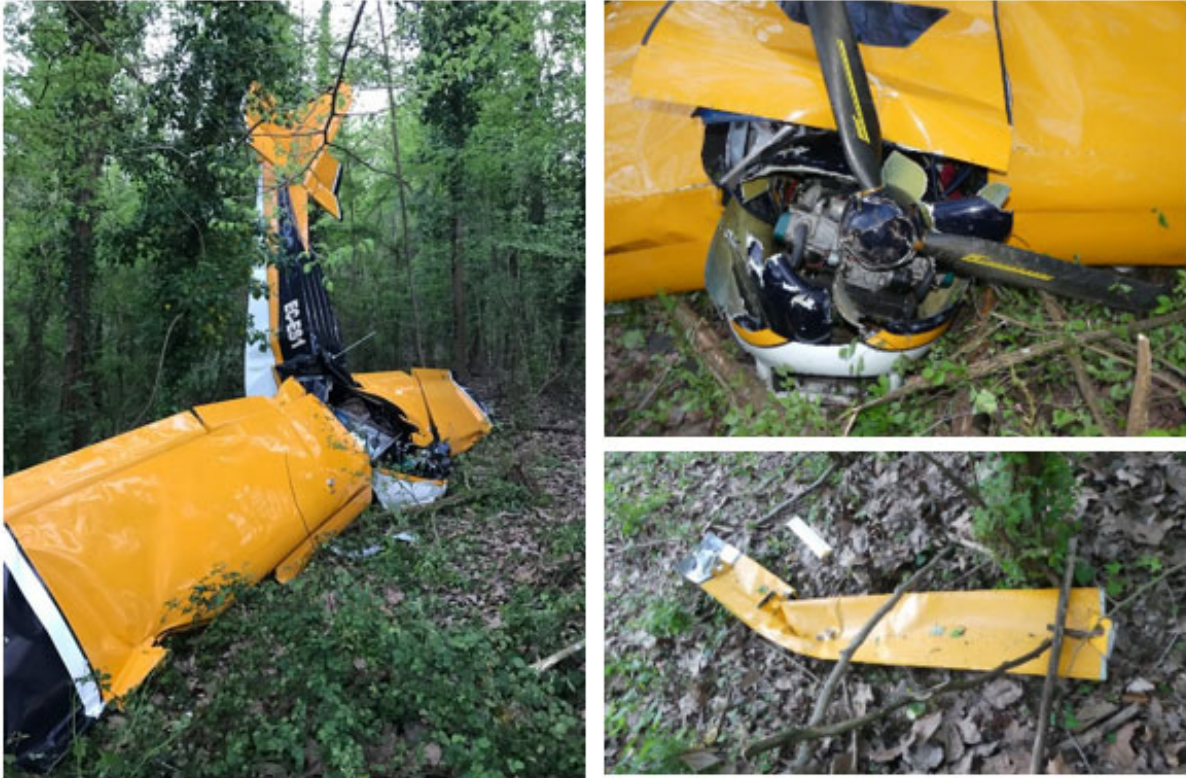
Figura 2. Vista general de la aeronave (izquierda). Fotografías de detalle del motor y la hélice (superior derecha) y del fragmento de slat desprendido (inferior derecha)
