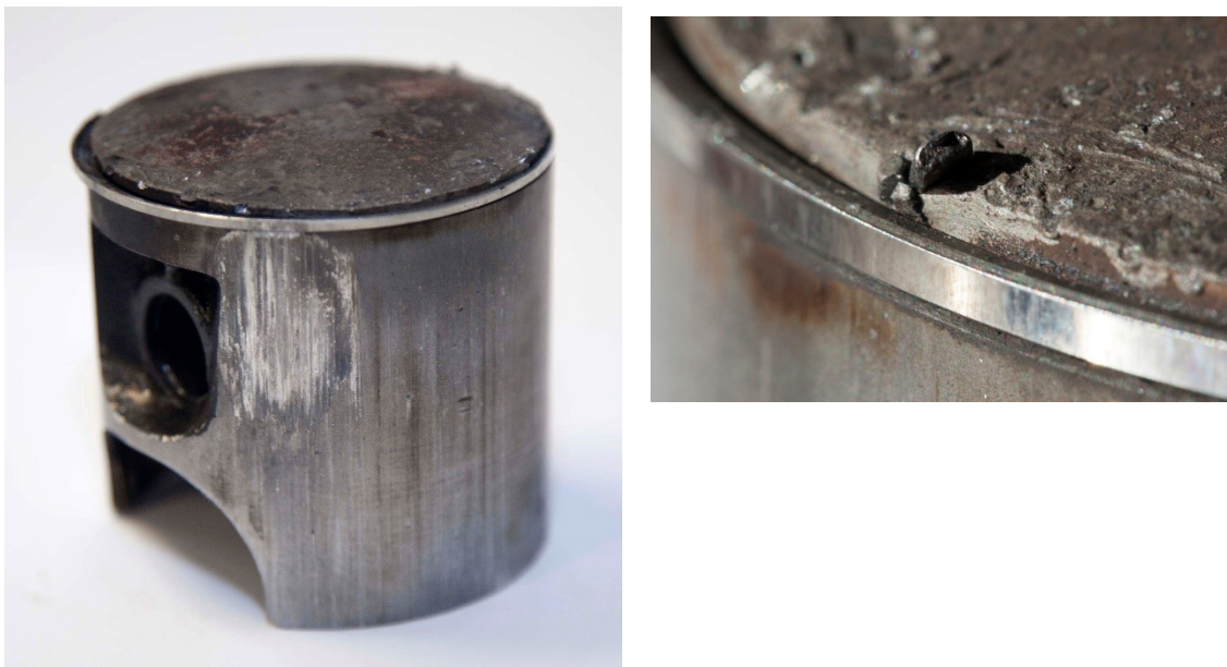
Figura 3. Fotografía del pistón (izquierda) y detalle de un trozo de aguja incrustado en la cabeza del pistón (derecha)
